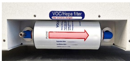
12.3 pav. Tinkamai įdėtas LOJ ir HEPA filtras
