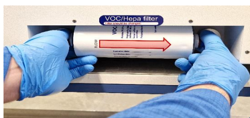
12.2 pav. LOJ ir HEPA filtro įdėjimo ir išėmimo procedūra
