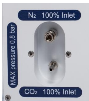
11.1 pav. Dujų tiekimo angos
